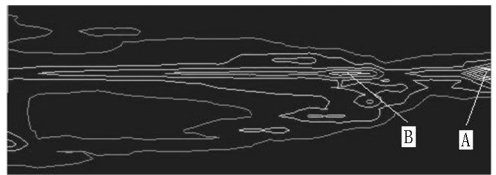
图6 斜面星轮齿面与实心辊轮接触等剪应力线图
